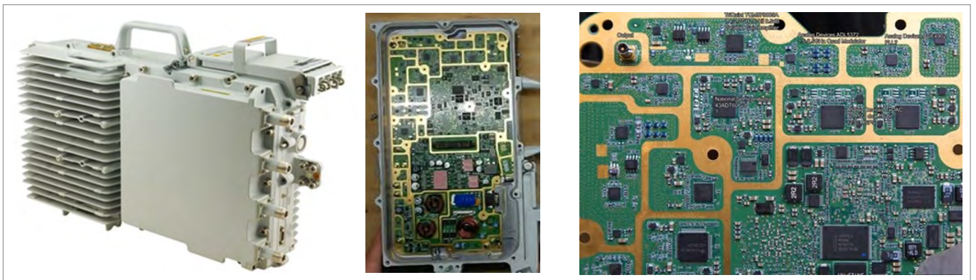
図6: 少なくとも8倍の薄型Dケースタンタルコンデンサを搭載した2018小型BS Huawei 4G LTE (写真: Kaizer Power Electronics YouTubeチャンネル)
