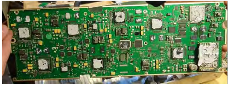
図5: 35個のD / Eタンタルコンデンサを搭載したBSNOKIA 4Gラック (~2014)の設計 (写真: Kaizer Power Electronics YouTubeチャンネル)
